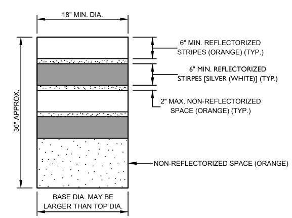
WHEN BALLAST IS REQUIRED BY THE ENGINEER, SAND SHALL BE USED. THE MAXIMUM WEIGHT OF THE BALLAST SHALL BE 50 LBS AND BE LOCATED APPROXIMATELY AT GROUND LEVEL.
